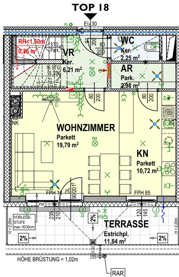
Der AR ist durch eine bauseits montierte Duschbox (= Ablauf) unter dem Bodenbelag vorbereitet für den künftigen, optionalen Einbau einer Dusche.
