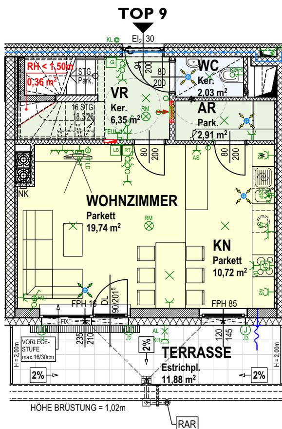
Der AR ist durch eine bauseits montierte Duschbox (= Ablauf) unter dem Bodenbelag vorbereitet für den künftigen, optionalen Einbau einer Dusche.
